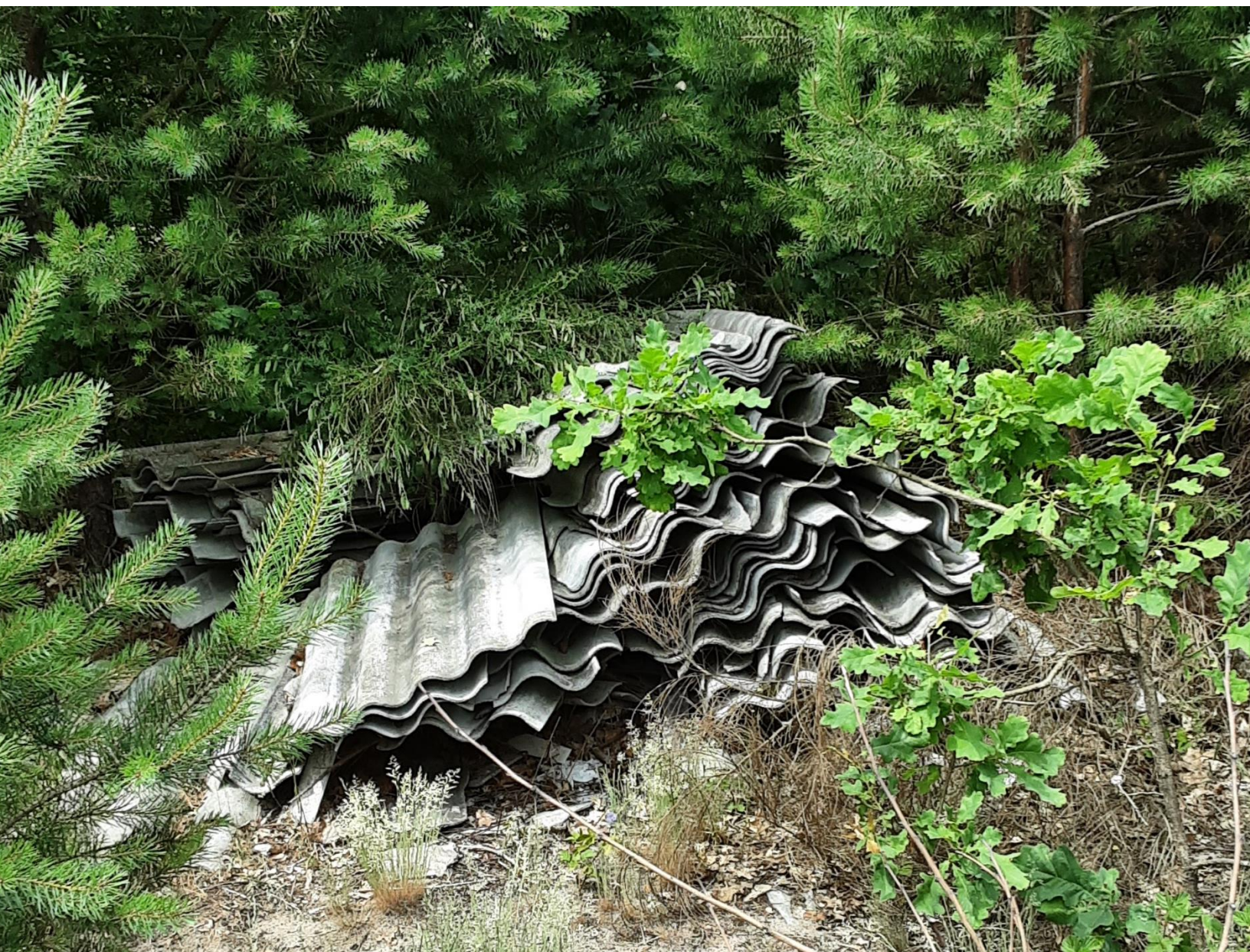
Fot. 4. Nielegalne składowanie wyrobów azbestowych.
